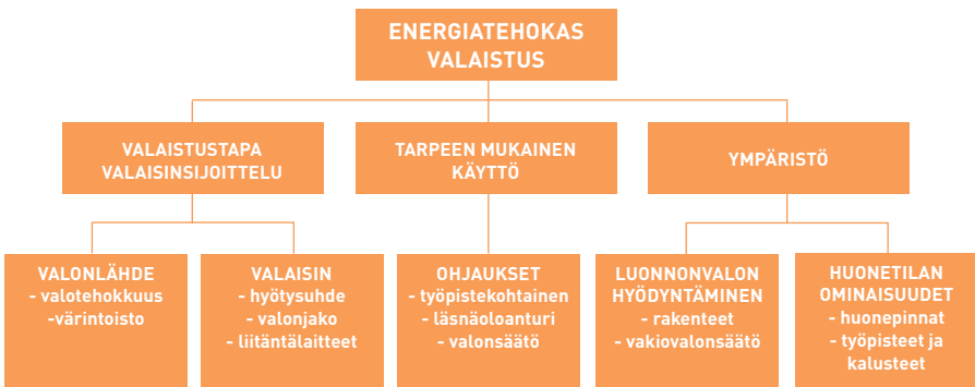
Kuva 1. Valaistuksen energiatehokkuuteen vaikuttavia tekijöitä
