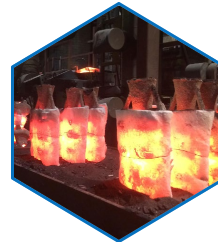
Sulan teräksen kaato suoraan keraamisiin muotteihin
