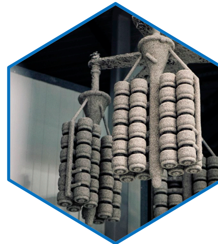
Vahapuiden kastaminen vuoron perään liemeen ja hiekkaan → näin syntyy keraaminen muotti vahan ympärille
